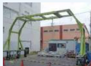
交通を阻害しない変形フレーム型点検システム
