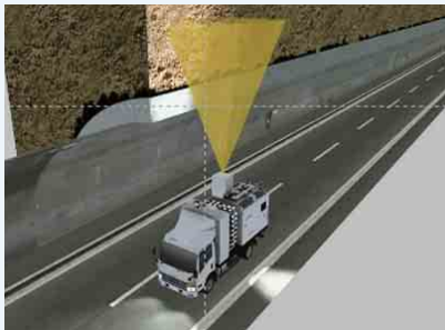
非接触レーダーによる点検・診断のイメージ図
