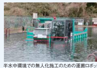
半水中環境での無人化施工のための運搬ロボット
