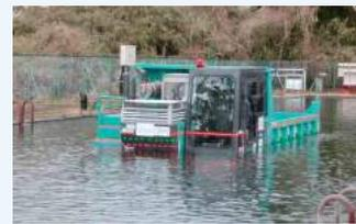
半水中環境での無人化施工のための運搬ロボット
