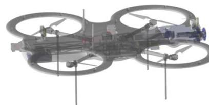
打音点検飛行ロボット
