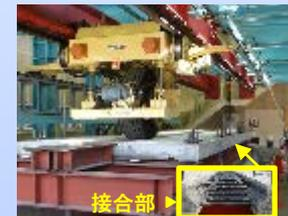
製品部材での定点疲労・輪荷重試験
