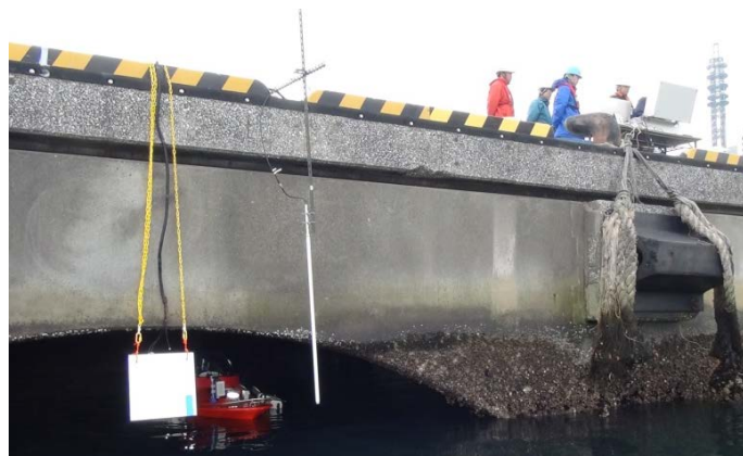
実橋橋におけるラジコンボートによる調査状況
