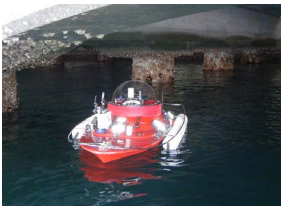
実橋橋におけるラジコンボートによる調査状況
