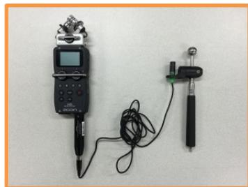
打診棒を用いた打音検査装置
