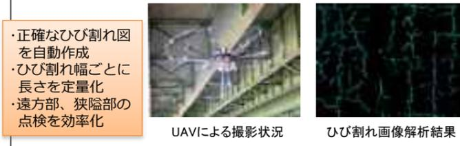
画像解析を用いた橋梁床版の点検
