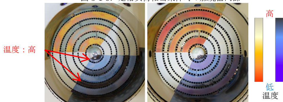
図 3-1-10. サーモペイント試験による高温箇所の特定
