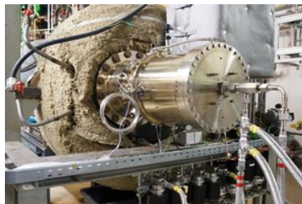
実機ガスタービン条件の水素燃焼試験
