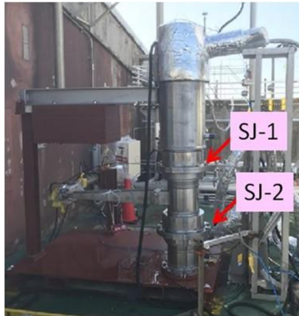
図 6．スィベルジョイント耐久試験
