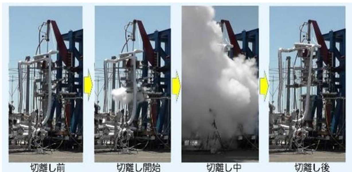
図 3．液化水素充填による緊急離脱機構の切離し動作試験
