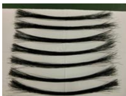
図3．100本単位処理の不融化で得られる 中空糸の外観
