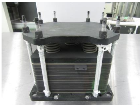
図 46 セラミックバネ方式の 200W 級ショートスタックの外観写真
