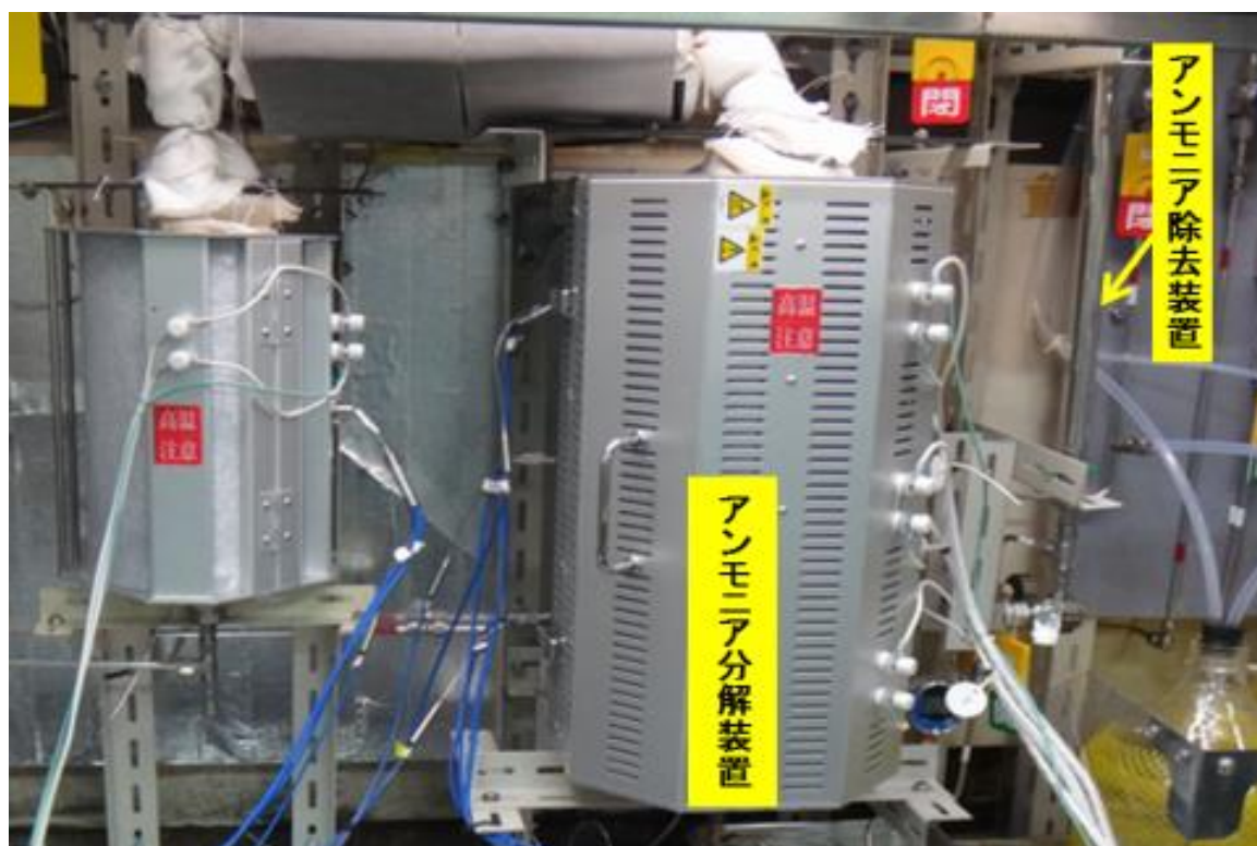
図2 アンモニア分解装置・アンモニア除去装置の外観
