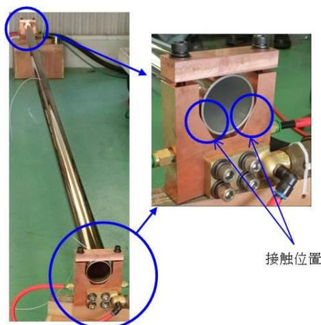
図 3-4-8. 直接通電加熱事前評価装置
