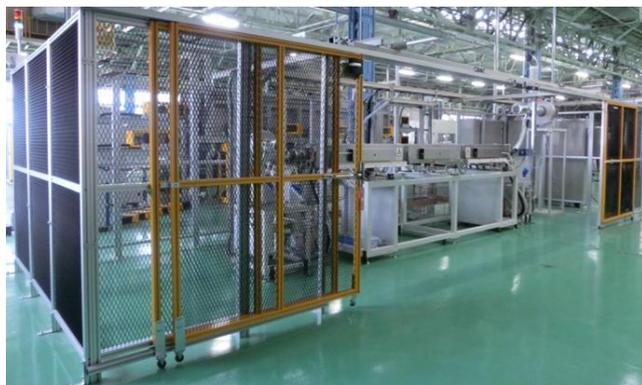
図 3-4-15. 真空封止装置外観写真
