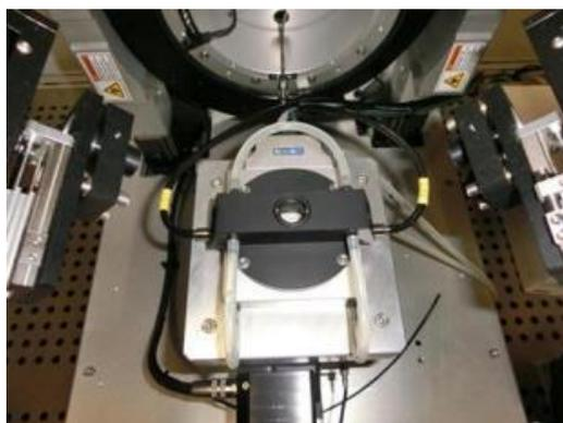
図 3-1-27. 試料加熱用ヒーターユニット
