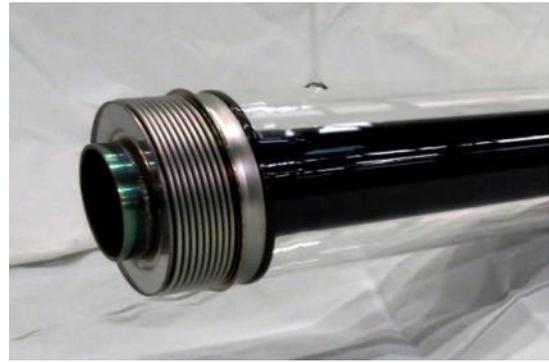
図 3-3-4. 650°C仕様集熱管構造と試作品写真
