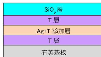
図 3-1-86. Ag+T 添加層の高温信頼性確認用の層構成
