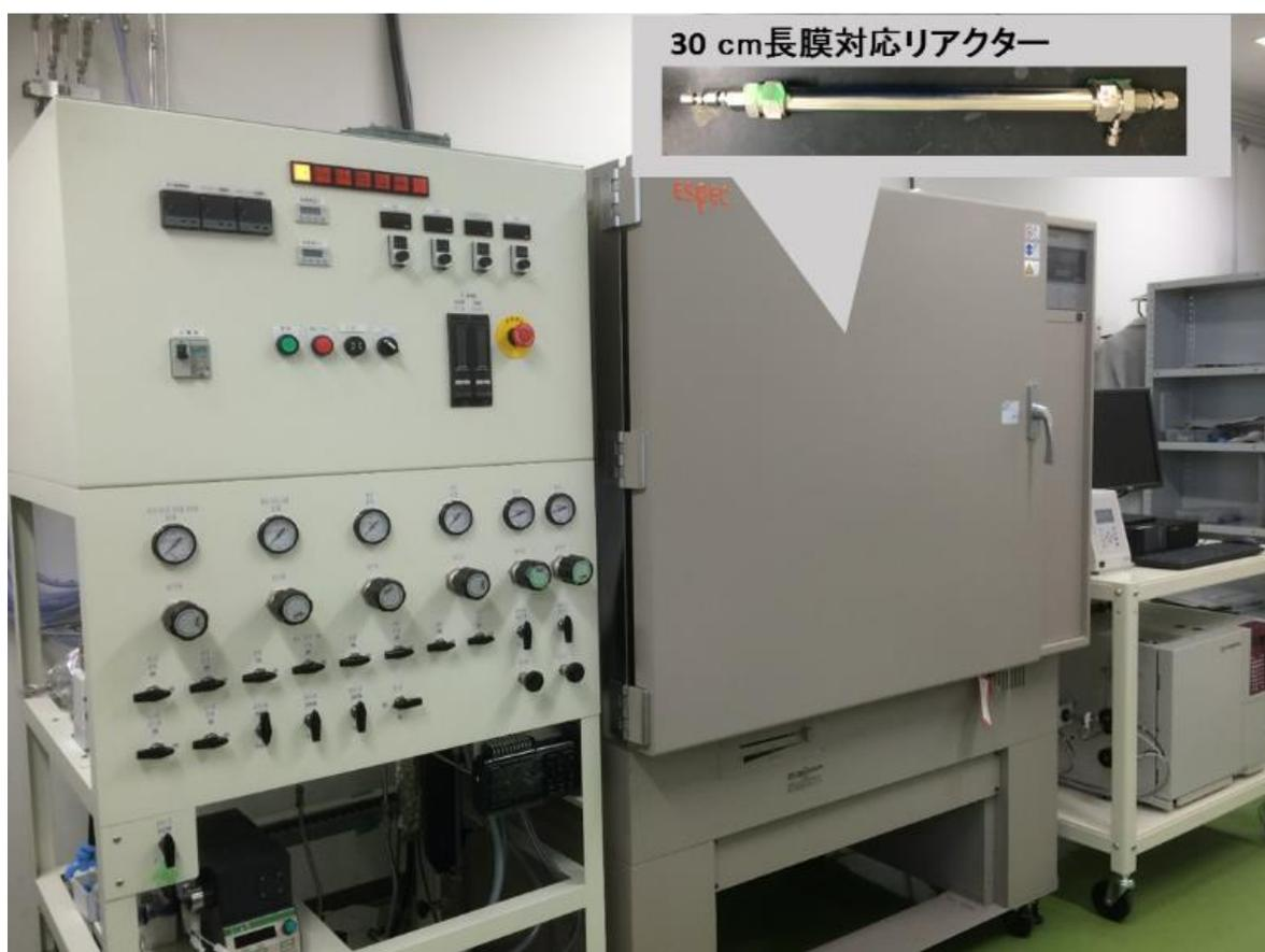
図 3-1-3-4 30 cm 長膜 ガス透過試験装置
