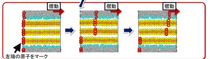
■MoS<sub>2</sub>層が1層だけでは、MoS<sub>2</sub>-DLC間に結合が生成し、摩擦力が上昇
