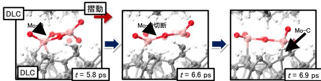
■摩擦により、Mo-O結合が切断し、Mo-C結合が生成
