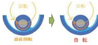
ローラー成膜装置(2016)では成膜ローラーが追従回転→成膜ローラーを自転させて転がりすべりを発現させることで樹脂液を流动させて固体潤滑剤の配向化を促進
