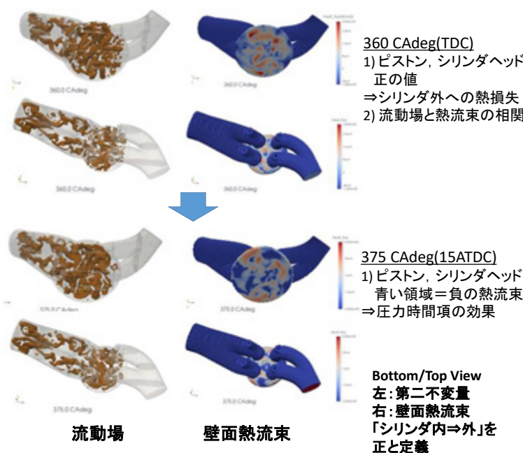
壁面熱流束 vs クランク角 サブモデル①, メッシュサイズ0.5mm
