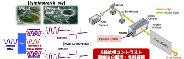
■ 最大撮影速度: 270,000 fps, 時・空間分解能: 150 ps, 1 μm
