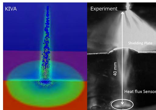
気相～液相部の熱伝達には壁関数、液膜内部の温度分布は1次元の熱伝導を仮定した従来の伝熱予測モデルの検証に着手
