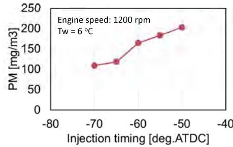
単気筒エンジンを用いて、暖機過程相当の定常試験におけるPM排出量の計測を行った。
