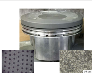
図1 スカート部への固体潤滑剤/タイルグ応用（表面塑性加工）
