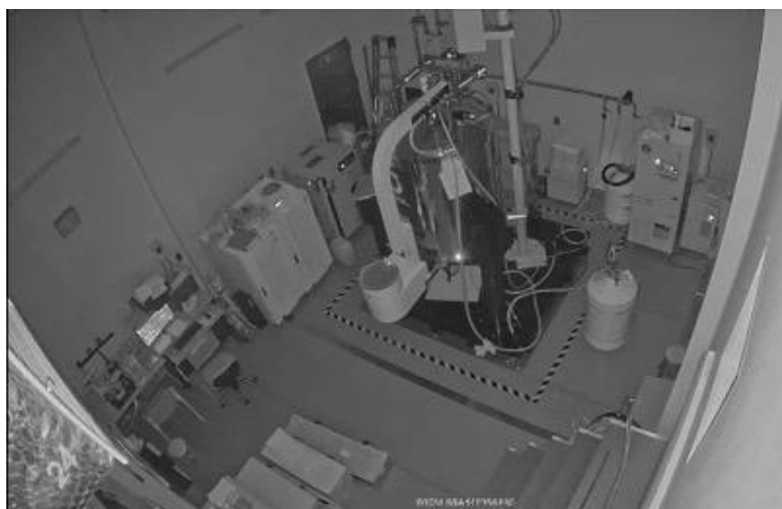
図 17 超伝導核磁気共鳴装置の遠隔監視システムのビデオキャプチャー画面
