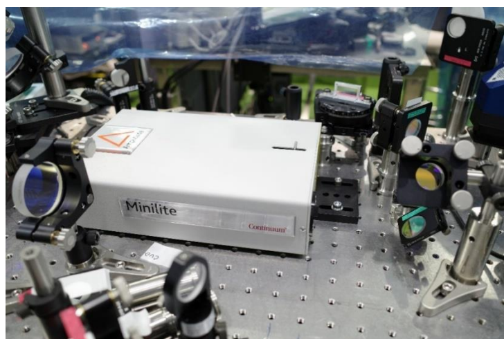
図 16 J-KAREN-P レーザー装置のフロントエンド部に導入した励起レーザー
