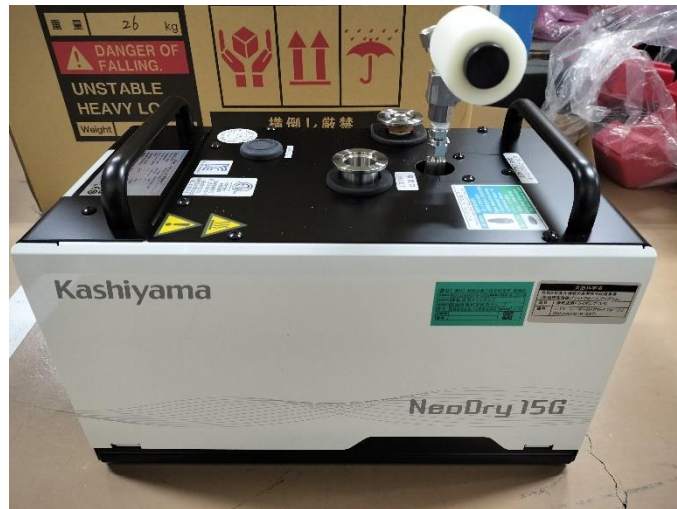
図 17 導入した遠隔制御可能な真空ポンプ
