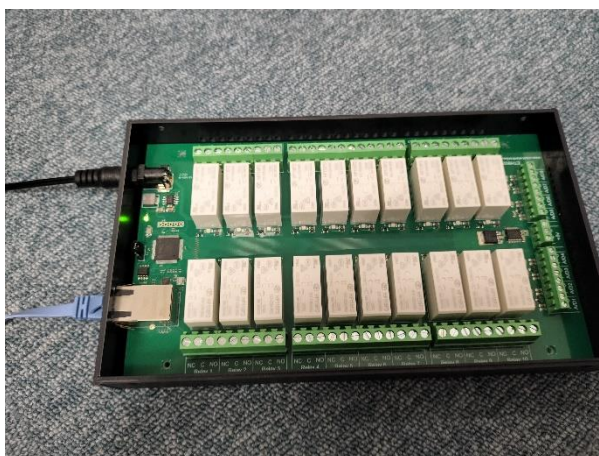
図 11 J-KAREN-P レーザー装置の繰り返し動作や計測器用トリガー時間を変更するためのリレーボード
