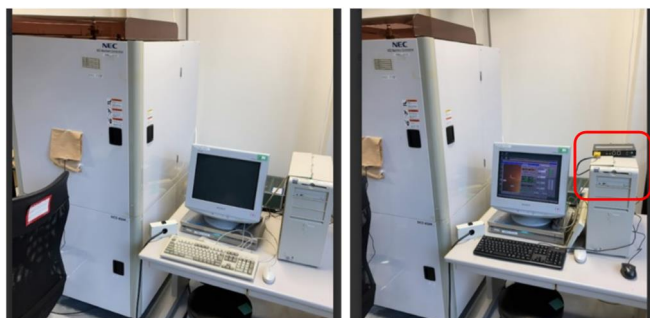
図 15 リモート化を導入前（左）と導入後（右）の結晶育成装置
