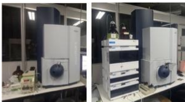
図 16 スマート化前（左）とオートサンプラー及び HPLC 導入後（右）の質量分析計
