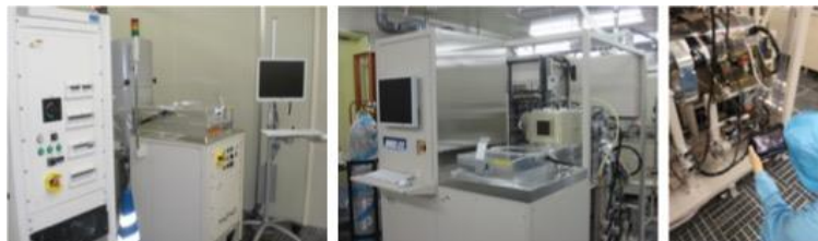
図 11 IP-KVM を導入した装置（左、中）とタブレット端末利用の様子（右）
