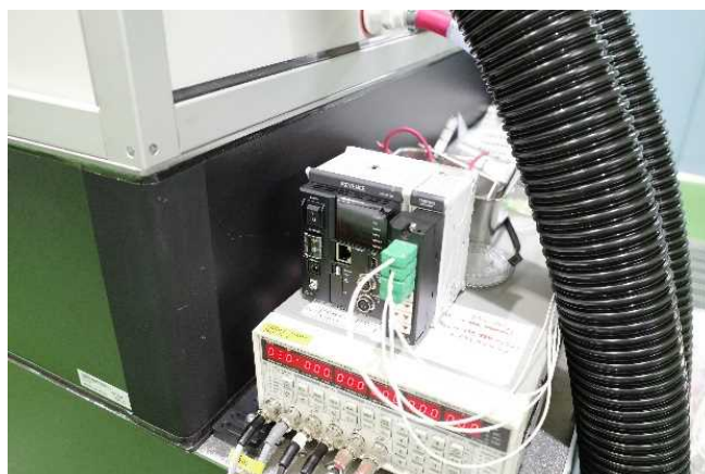
図 12 励起レーザー運転状況診断用データロガー
