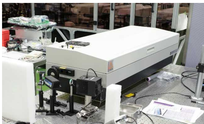
図 11 遠隔操作対応型前置増幅器部用励起レーザー
