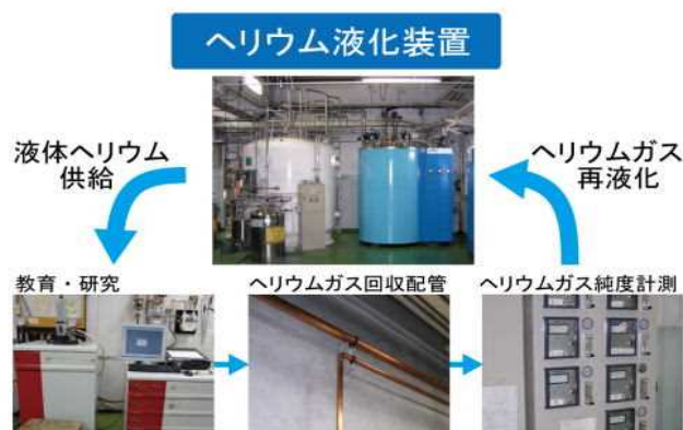
図 13 低温センターが行っているヘリウムガスの学内リサイクルの模式図。液体ヘリウム供給予約システムは、液体ヘリウムの供給予約だけでなく、ヘリウムガス回収量の研究室からの申告値をオンライン集計する機能や、各研究室の供給実績等の管理・集計機能も有し、ヘリウムガスの学内リサイクルを効率良く管理する基幹システムとして活用されるようになった。
