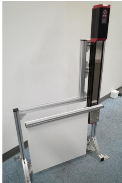
図 8 直径 260 mm レーザー用遠隔レーザー遮光システム.
