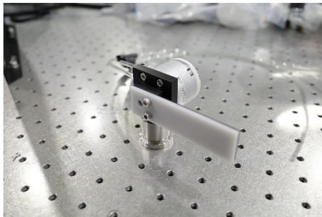
図 7 直径 20 mm レーザー用遠隔レーザー遮光システム.
