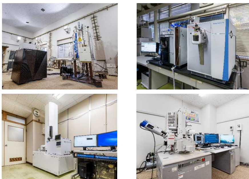
図4．重点運用設備・機器：核磁気共鳴装置（左上）、フーリエ変換型質量分析装置（右上）、飛行時間型質量分析装置（左下）、電界放出型走査電子顕微鏡（右下）
