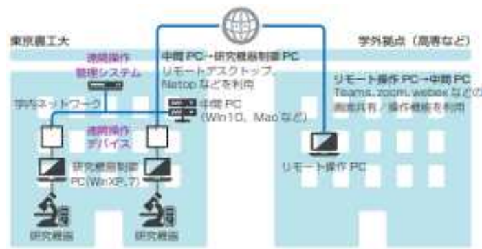
図5 共用機器リモート化への学内ネットワーク接続概要図
