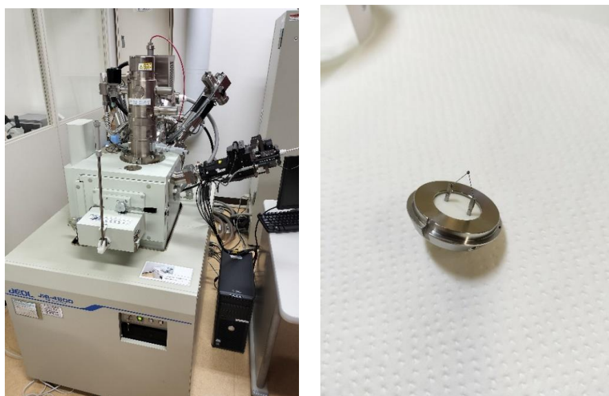
図 17 JIB-4500 外観 (左)、交換したフィラメント (右)
