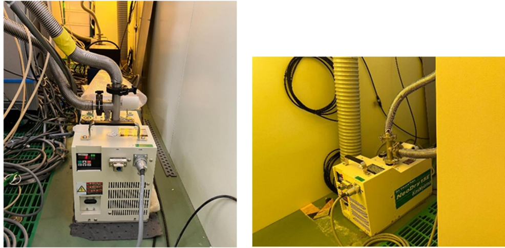
図2 スパッタリング装置に装着したドライポンプ（左）、真空蒸着装置に装着したドライポンプ（右）
