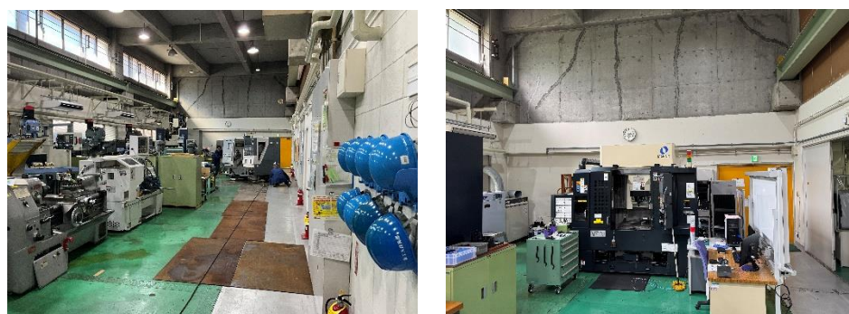
図 9 NC 旋盤搬出（左）、立型マシニングセンタ設置状況（右）
