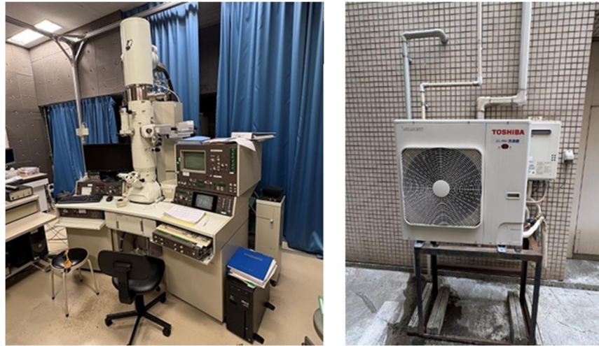
図 13 JEM-2010F 外観（左）、交換後のチラー室外機（右）
