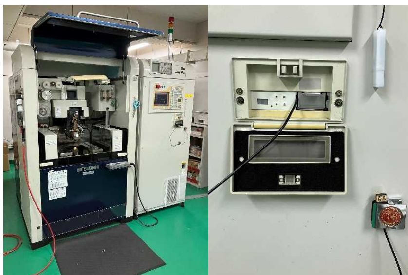
図3 ワイヤ放電加工機全景（左）とFDD-USB化実施部（右）
