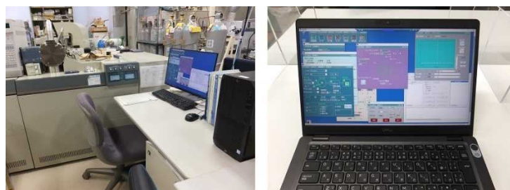
図7．二重収束質量分析計の更新したPC（左）と別のPCからのモニタリング（右）
