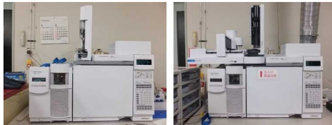
図4. GC-MS の変更前（左）とオートサンプラー導入後（右）
