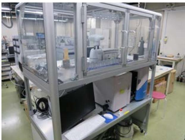
写真1 自動試料投入機構を装着したレーザー回折・散乱式粒子径分布測定装置
