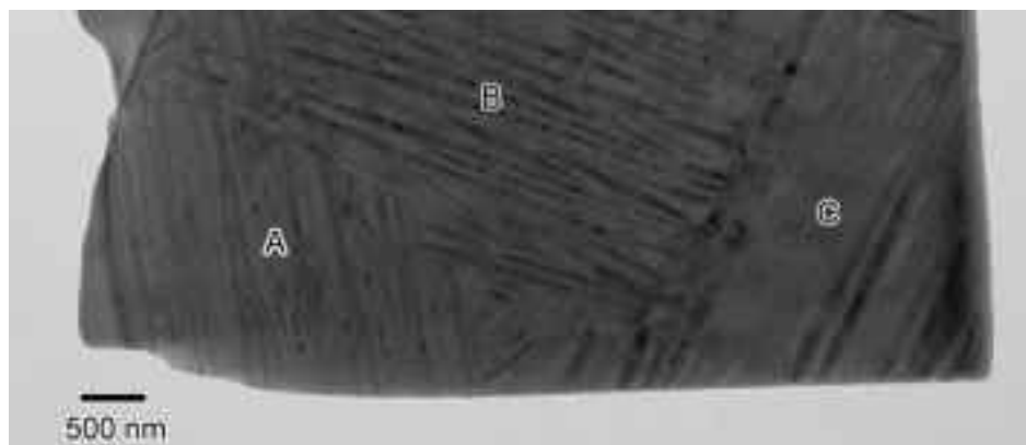
図 8 薄片化した \text{Co}_{0.6}\text{Fe}_{0.9}\text{Mn}_{1.5}\text{O}_4 の TEM 像 ラメラ状組織の存在を示す結果
