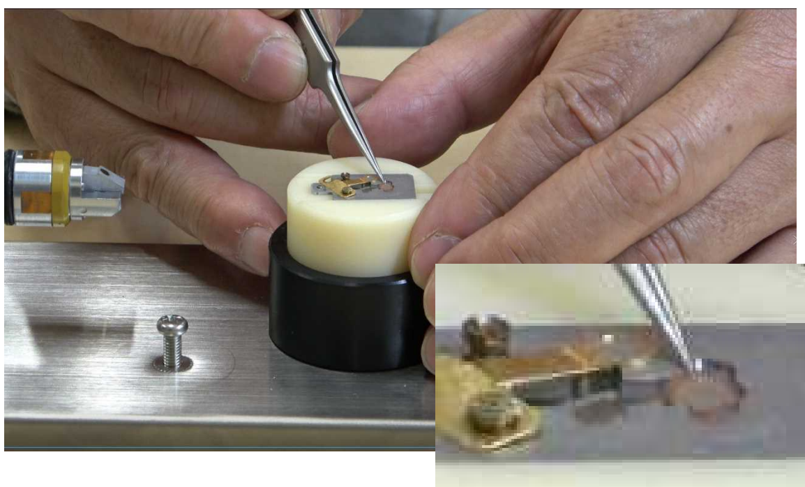
図 3 4K ビデオで撮影した電界放出型透過電子顕微鏡の試料セッティングとその拡大図
