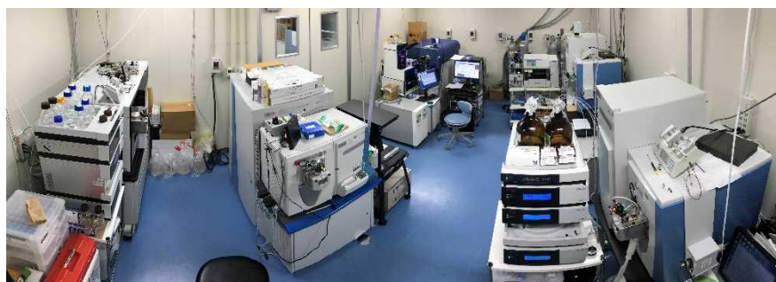
写真②：共用利用専用実験室に配置した質量分析装置（4台）
