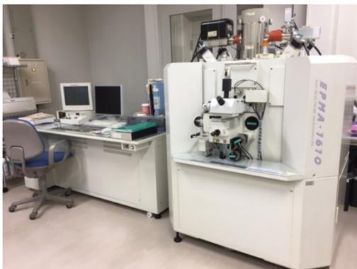
図 7. 電子線マイクロアナライザ
