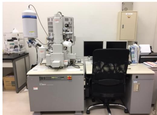
図 8. 走査型電子顕微鏡
