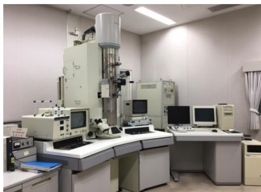
図 3. 透過型電子顕微鏡
