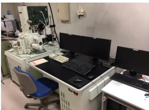
図 9. 走査型電子顕微鏡
