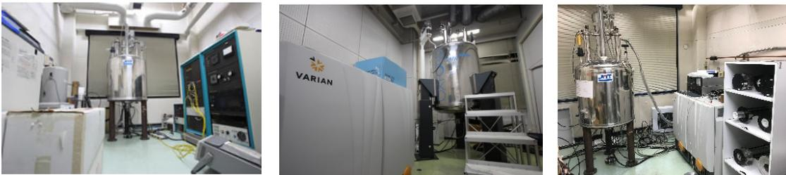
図 6. 今後も安定的に機器運用ができるように、メーカー保証が終了した 2 台を、1 つの NMR に統合再生。(左) (中央) それぞれメーカー保証が終了した CMX300 と VNS600。(右) 2 台から再生した VNS300。
