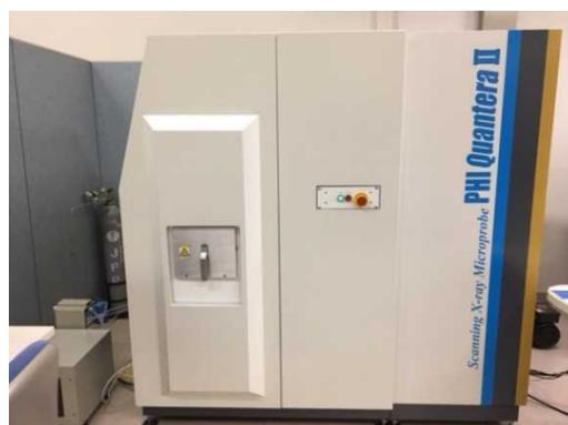
図9. 走査型 X 線光電子分光分析装置
