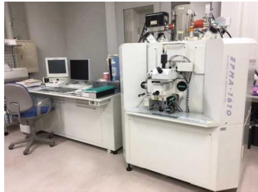
図 5. 電子線マイクロアナライザ
