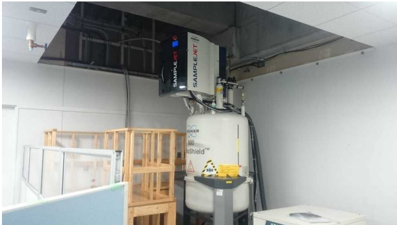
写真⑦：共用利用専用実験室に配置した核磁気共鳴装置
