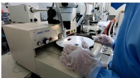
写真3. 試料用シリコンウェハを加工する様子
