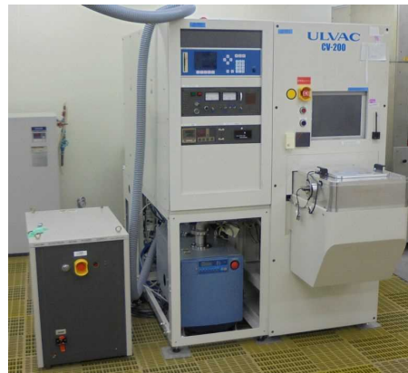
ロードロック(LL)式電子ビーム蒸着装置
