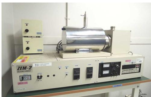
図 8 熱電特性評価装置
