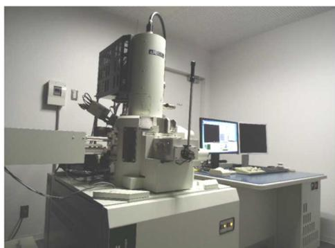
図 2 集束イオンビーム走査電子顕微鏡
