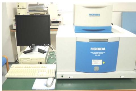
図 9 粒子径分布測定装置
