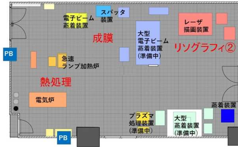
図7 機器の再配置・移設後のクリーンルーム（成膜、熱処理区画）
