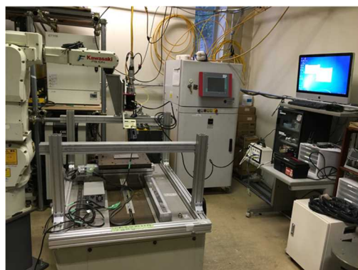
図1 高出力半導体レーザ加工システム
