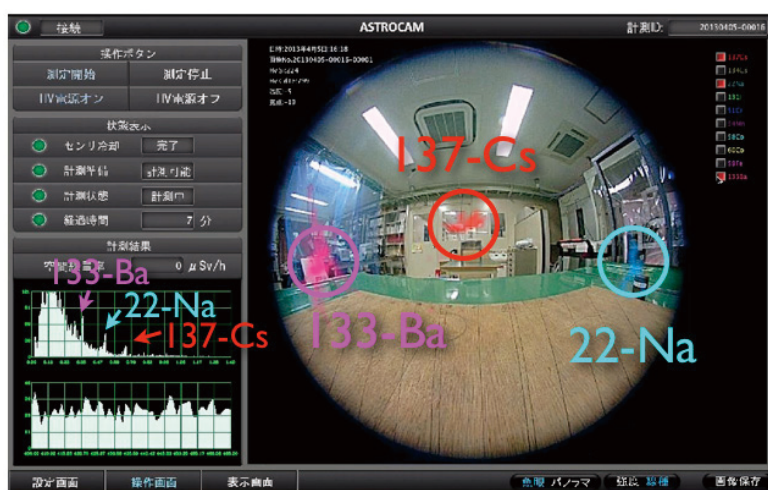
図3 「ASTROCAM 7000HS」の測定例。 133-Ba、137-Cs、22-Naを同時に測定し、133-Baをピンク、137-Csを赤、22-Naを水色で表示した。
