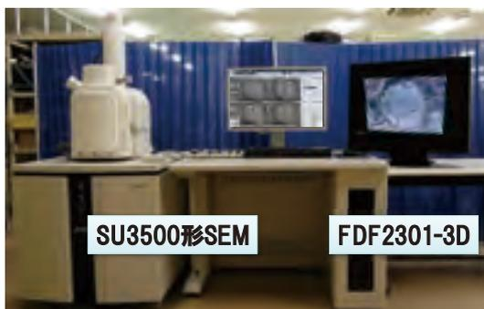
図4 SU3500形走査電子顕微鏡とFDF2301-3Dの組合せ外観
