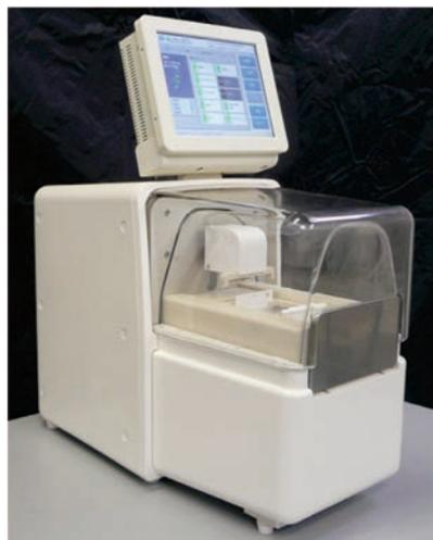
全自動2次元電気泳動・転写装置 実用化試作機
