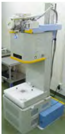
図2 位相型高感度X線医用診断機器。
