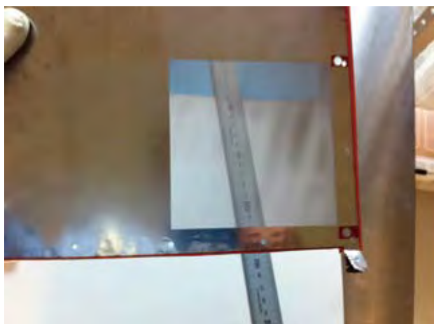
光電コンバータの試作。透けて見える部分が 高効率光電変換のための加工部
