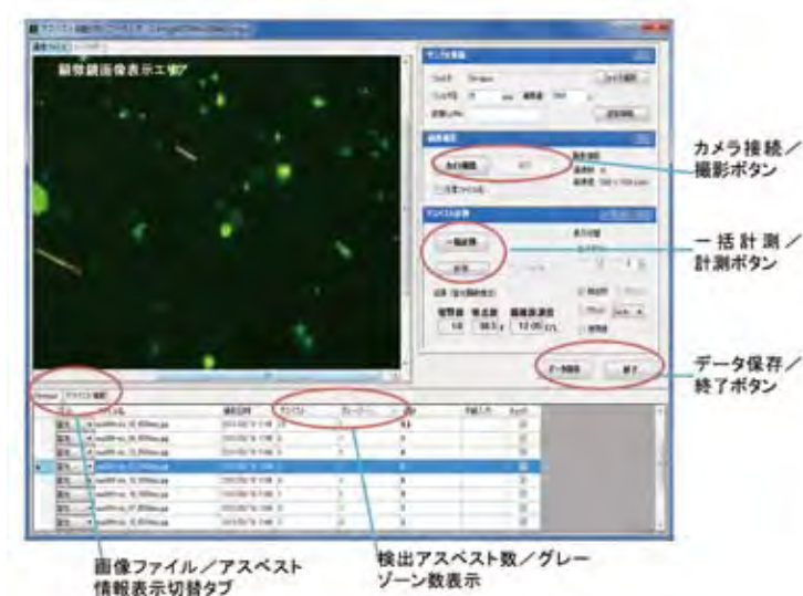
図2 アスベスト自動計測ソフトウェア操作画面
