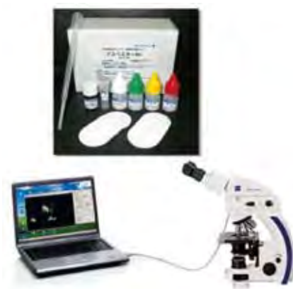
図3 携帯可能なアスベスト自動計測システム
