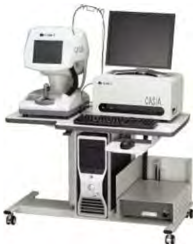
三次元前眼部診断装置CASIA（左）とCASIAによって撮影されたヒト前眼部の三次元断層（右）。
