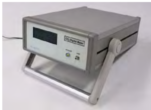
図3 学校教育用CO 2 計 試作機
