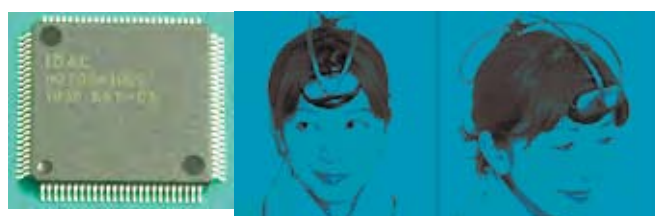
開発したLSI（左）と試作機（右）
