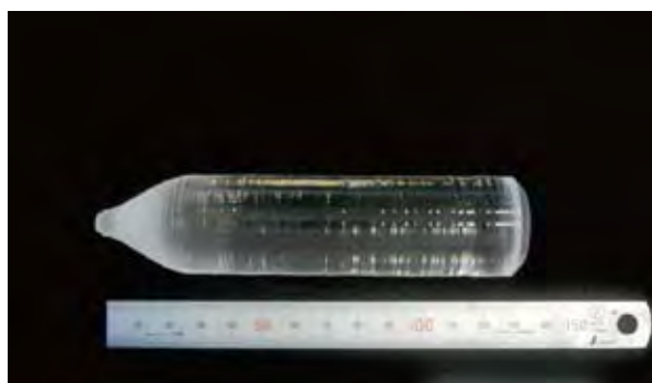
図1 育成した大型LiCaAlF 6 シンチレータ結晶。直径1インチ×13 cm
