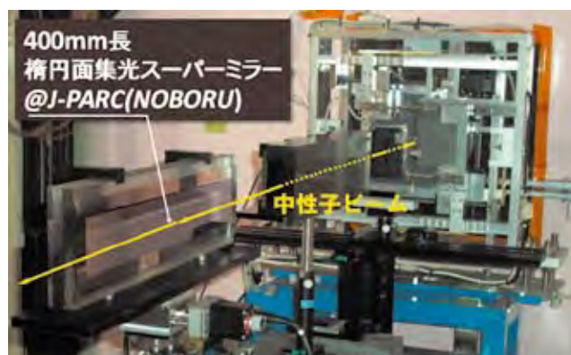
図1 J-PARCにおける長尺楕円面集光スーパーミラーの集光性能評価
