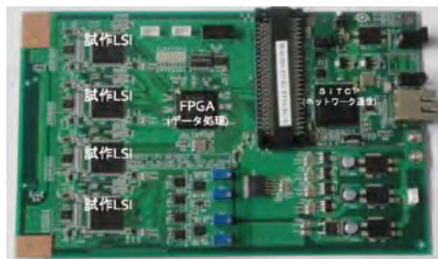
GEM信号を処理する試作LSIおよび読み出しボード
