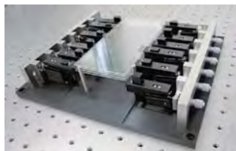
図3 厚さ1mmの楕円面ミラー基板を4枚スタックした多重集光ミラーデバイス
