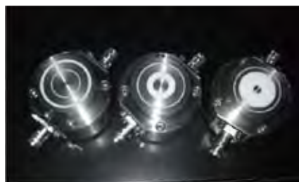
図2 （左）平面終端高周波測定用電極。（右）平面終端低周波測定用三軸型電極。
