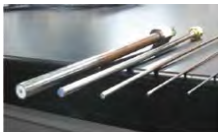
図2 （左）平面終端高周波測定用電極。（右）平面終端低周波測定用三軸型電極。
