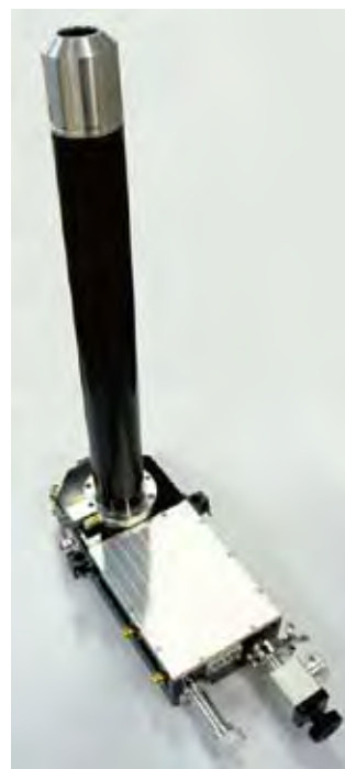
FIG 3. 検出系冷却型-固体高分解能NMRプローブ実験試作機。7T~14Tワイドボアマグネットに対応する。
