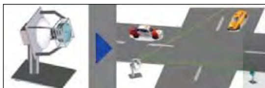
図4 可搬型モデルによる車排ガス監視の応用例
