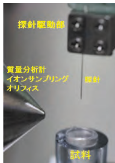
図2 探針エレクトロスプレーのシステム
