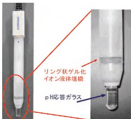
図1 pH測定用の参照電極複合型ガラス組込ゲル化C8mimC1C1N塩橋
