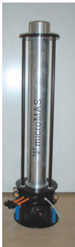
図1 開発した高感度高分解能固体NMRプローブ
